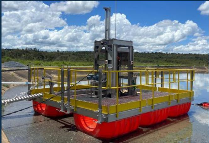
A remoção de lodo em lagoas de sedimentação é um processo essencial para a manutenção da eficiência operacional de sistemas de tratamento de efluentes. Tradicionalmente, essa remoção exige paradas operacionais e procedimentos manuais que resultam em custos elevados e perda de produtividade. Para otimizar esse processo de maneira contínua e eficiente, o Grupo H2O desenvolveu a Balsa de Remoção de Lodo Automatizada.
